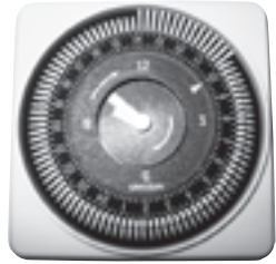
Fonctionnement des filter/ chlorateur réglé pour 3,5 heures 10h 15 à 13h45.
